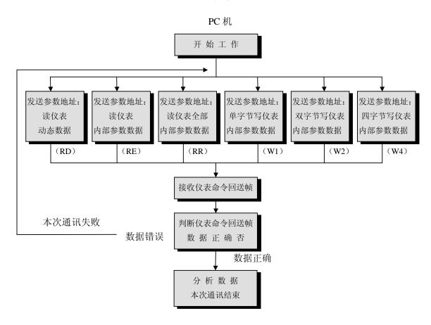
例: PC 机欲从 RS-485 总路线挂接的仪表中读取 1 号单显 I 型仪表的 AL1 设定(当前设定值为 1598)。 通讯流程如下:
